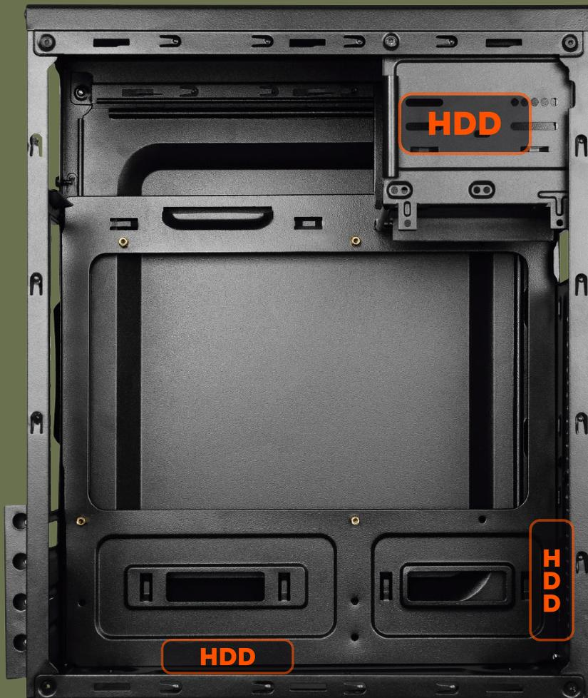
Ajuste o HDD na posição correta, de forma que as furações do HDD se alinhem com a furação do gabinete, então utilize os parafusos correspondentes para fixação.
