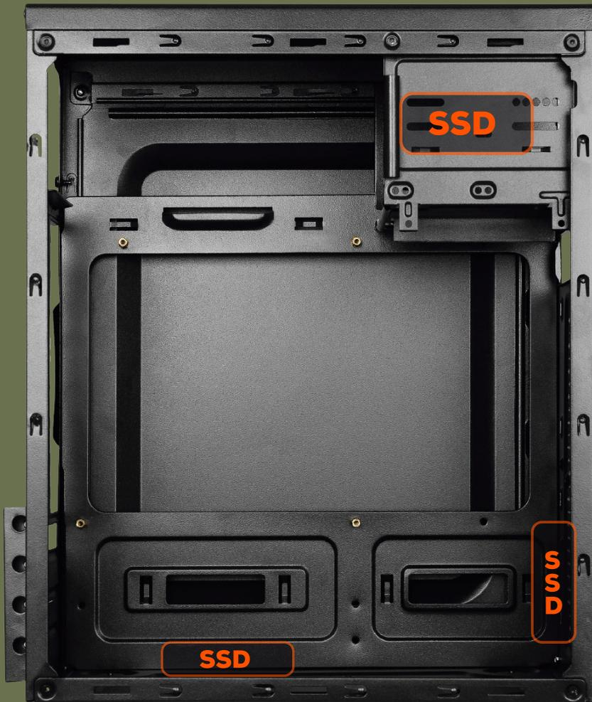
Ajuste o SSD na posição correta, de forma que as furações do SSD se alinhem com a furação do gabinete, então utilize os parafusos correspondentes para fixação.
