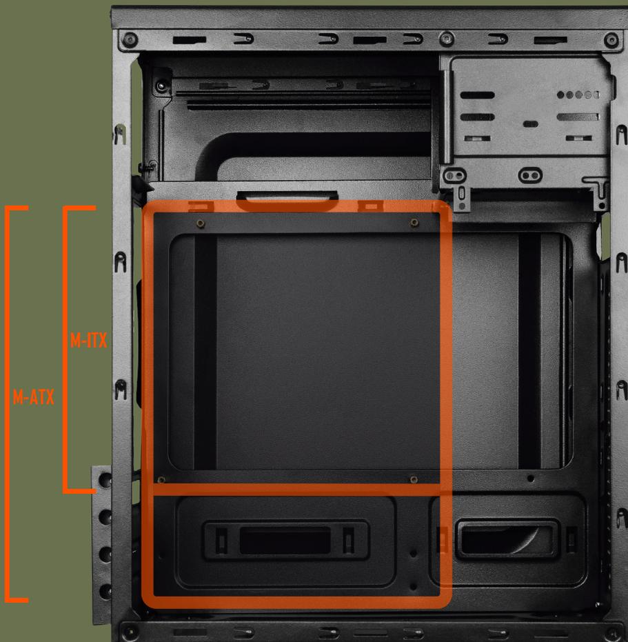
**Posicione a Placa-Mãe, alinhando as furações com as do gabinete, e fixe-a utilizando os parafusos correspondentes.**
