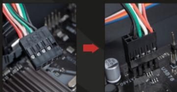
Encontre o conector USB 2.0 e conecte no slot correspondente na placa mãe. A localização do slot encontrada no manual da placa mãe.
