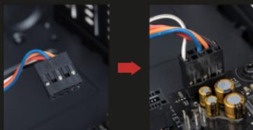
Encontre o conector de áudio do PCB e conecte-o ao slot correspondente na placa mãe. A localização de o slot é encontrada no manual da placa mãe.
