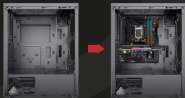
Encontre o local instalação da VGA e instale-a com os parafusos de montagem.
