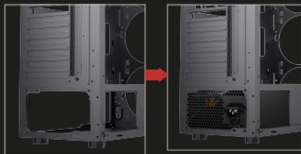
Encontre o local da fonte de alimentação e instale-a com parafusos. Comprimento máximo da PSU: 190mm incluindo espaço para cabos.
