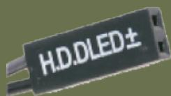
Conecte o LED referente ao disco rígido aos pinos na Placa-Mãe onde estiver marcado "HDD LED/HD LED/HLED ou IED LED".
