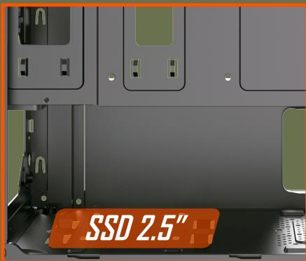
Para a instalação do SSD, posicione-o na base com as furações alinhadas com as do gabinete, e fixe-o com os parafusos correspondentes pela parte inferior do gabinete.
