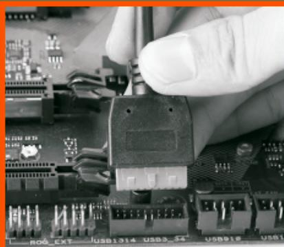
Identifique o conector do USB 3.0 no gabinete e o soquete de instalação na Placa-Mãe. Alinhe o conector com o soquete de acordo com a imagem ao lado, encaixando o guia presente no conector com o encaixe presente no soquete da Placa-Mãe.
