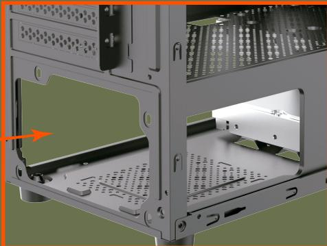
Fixe a fonte de alimentação utilizando os parafusos adequados.
