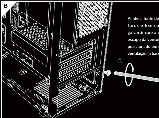
Alinhe a fonte de energia com os quatro furos e fixe com parafusos. Favor garantir que a entrada do PSU ou o escape da ventoinha esteja instalado e posicionado em direção as entradas de ventilação (a baixo) do gabinete.
