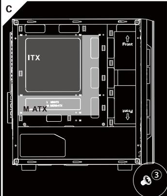
Instale a placa, garantindo que os pontos de montagem de cobre estejam posicionados na posição correta com a Placa-Mãe e segura com os parafusos de montagem (n°3). Note que alguns pontos de cobre são fornecidos se necessário.
