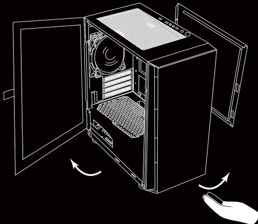
• Para remover o painel frontal, favor remova os painéis laterais retirando todos os parafusos. Puxe a alça do lado esquerdo para abrir o painel articulado de vidro, uma vez aberto deslize cuidadosamente o painel de vidro para fora das dobradiças para o afastar completamente da estrutura e coloque uma mão em cima do gabinete e com a outra mão empurre cuidadosamente por baixo para remover.
