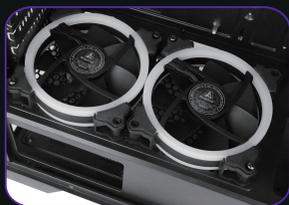
Instale a ventoinha do suporte de armazenamento da fonte de alimentação (trava com 8 parafusos de alongamento)
