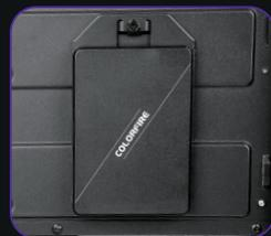
Reinstale a placa traseira para SSD e fixe com parafusos.
