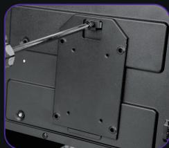
Solte os parafusos, retire a placa traseira de instalação do SSD do lado direito do gabinete.
