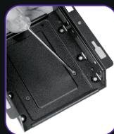
Instale o SSD na parte de cima do suporte e fixe com parafusos.
