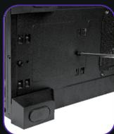
Solte os parafusos de suporte de disco rígido removível de duas peças inferiores.
