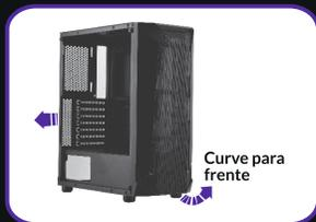
Solte os 4 parafusos do lado esquerdo e 2 parafusos do lado direito do vidro traseiro. Abra o painel lateral, curve a parte inferior do painel e puxe o painel para abrir.
