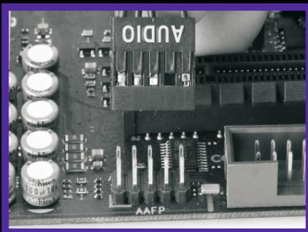
**Em seguida conecte o Áudio HD ou o Áudio no encaixe adequado.**
