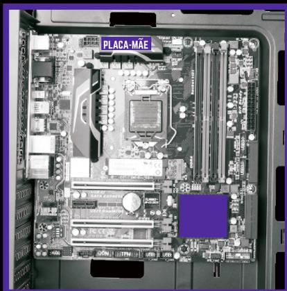
**Em seguida posicione a Placa-Mãe (conforme indica a imagem acima).**
