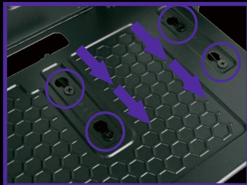
Deslize o HDD com os parafusos pré-instalados conforme indica a imagem.
