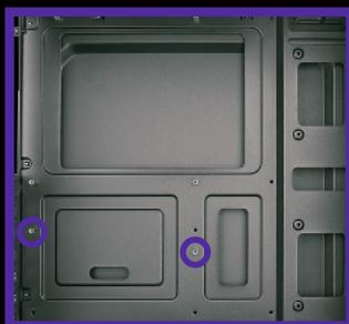
Certifique-se de que os espaçadores pré-instalados estejam na furação compatível com o modelo de sua Placa-Mãe.
