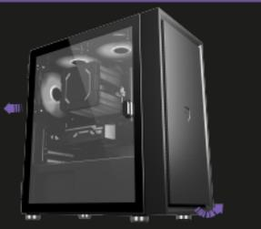
Afrouxe os parafusos em ambos os lados do gabinete e então, remova os painéis da esquerda e direita, solte o cabo de amarração, segure o botão da parte frontal e puxe para frente para abrir.
