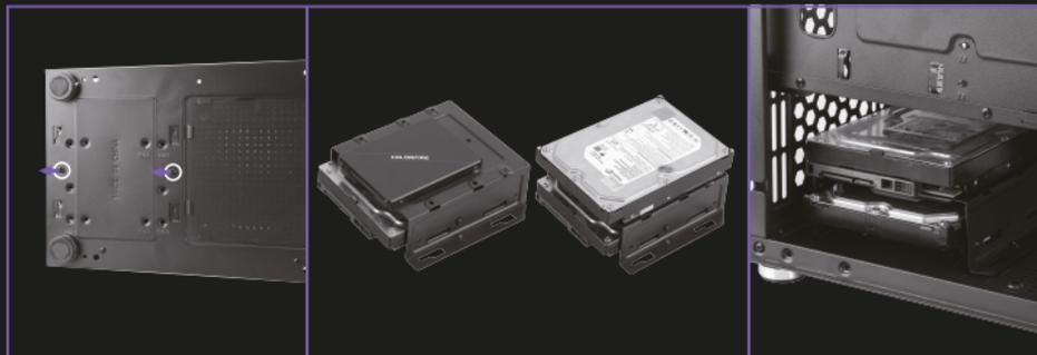
A base do gabinete possui suporte em sua base para 2 HDD3.5" ou 1 HDD 3.5" + 1 SSD 2.5". Retire o suporte de HDD, depois prenda os HDDs no suporte e então fixe o suporte de volta à capa da PSU. (sugerimos que prenda o HDD mais espesso na parte de baixo do suporte)
