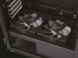
A capa da PSU suporta 2 ventoinhas de 120mm. Fixe as ventoinhas na capa da PSU utilizando os parafusos grandes.
