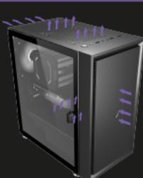
Diagrama esquemático do fluxo de ar.
