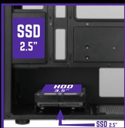
Reposicione a baía de armazenamento e fixe-a com os parafusos pela parte inferior do gabinete.
