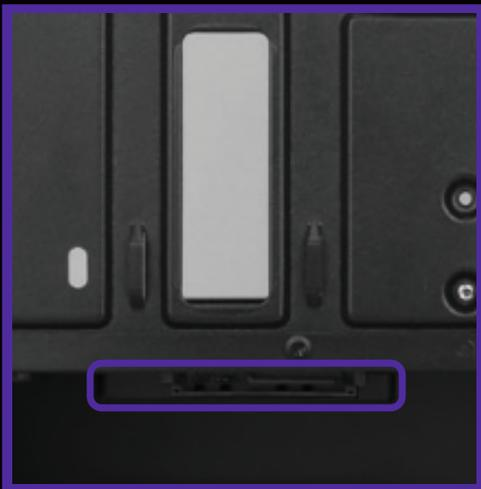
**Fixe-o com os parafusos pela parte interna do gabinete.**
