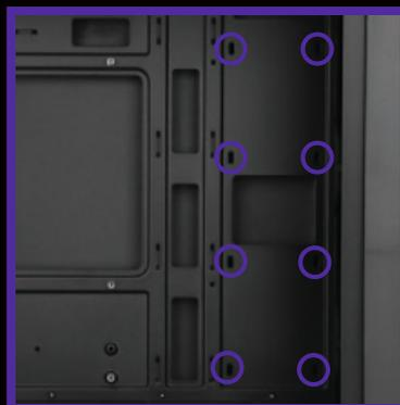
Posicione o SSD e fixe-o com os parafusos conforme indicam as imagens.
