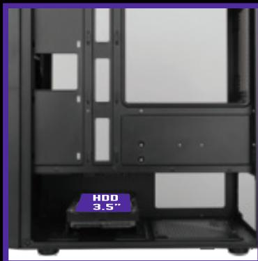
Remova os parafusos da baia de armazenamento pela parte inferior do gabinete.
