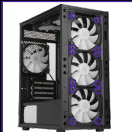
Posicione as ventoinhas pela parte interna do gabinete, e fixe-as com os parafusos pela parte frontal do gabinete.
