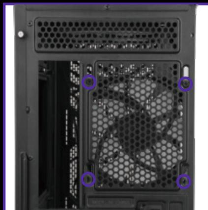
**Posicione a ventoinha pela parte interna e fixe-a com os parafusos pela parte traseira do gabinete.**
